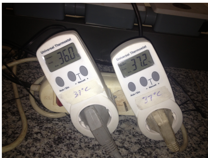
Figura 4.9 - Termostato com controle de temperatura com sensores externos
