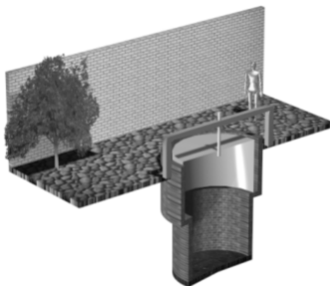
Figura 2.5 - Representação tridimensional em corte do biodigestor modelo batelada.
