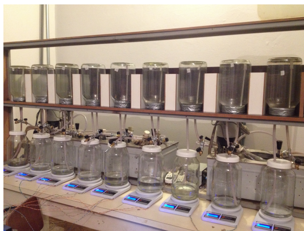
Figura 4.5 - Visão geral da bancada com nove conjuntos de bioreatores.
